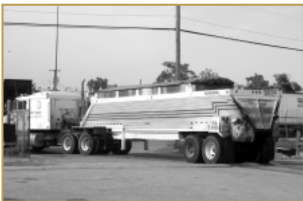
Figura 1.- Ilustración del traslado de la mezcla al lugar de obra.
